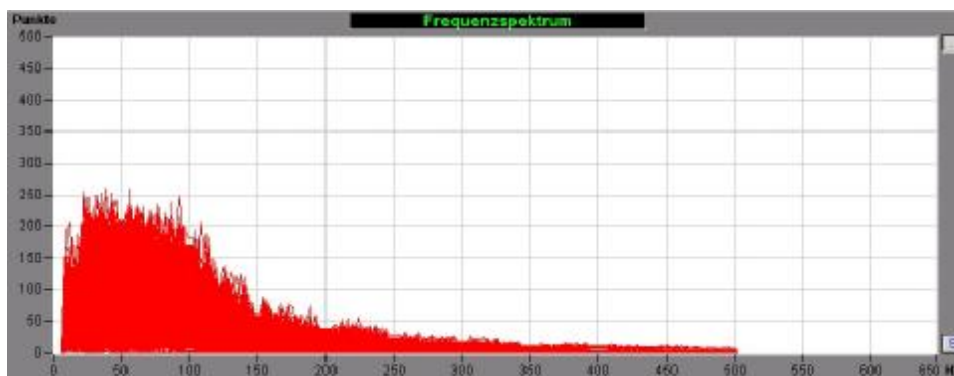
Abb. 4: OEMG-Frequenzspektrum, Netzfrequenz und Oberwellen mit Frequenz-Mittelwert-Filter entfernt.
