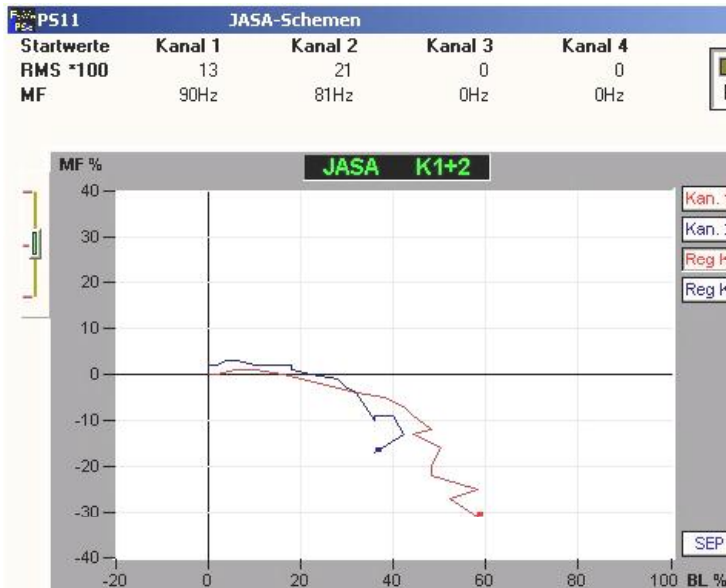
Abb. 7: Darstellung der prozentualen Veränderungen der spektralen Gesamtleistung (Abszisse) und der Medianfrequenz (Ordinate) zweier OEMG-Kanäle (2*biceps) auf dem Display eines an das PS11 angeschlossenen PC (Bildschirmausschnitt).
